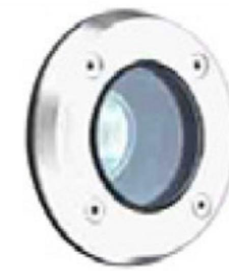
**โคมไฟใต้น้ำ** โคมไฟที่ถูกออกแบบมาโดยเฉพาะ ใช้งานในสระว่ายน้ำ บ่อน้ำตก บ่อปลา ซึ่งต้องต่อพ่านหน้าแปลงเพื่อแปลงกระแสไฟฟ้าให้เหลือ 12V หรือ 24V เป็นการป้องกันไม่ให้เกิดอันตรายแก่ผู้ที่สัมผัสหน้าโดยตรงในกรณีที่เกิดกระแสไฟฟ้ารั่ว วัสดุที่นำมาทำตัวโคมจะใช้สแตนเลสเพื่อป้องกันการกัดกร่อน และมียางกันน้ำไม่ให้ซึมเข้าไป
