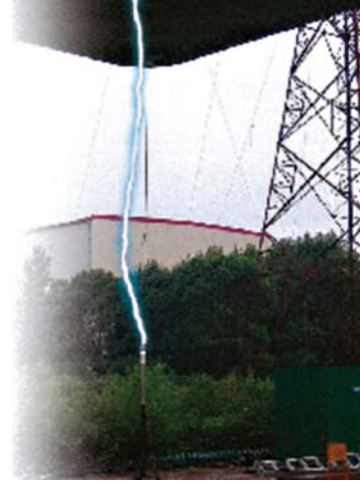
ภาพแสดงการถ่ายเทประจุ (discharge) บนหัวล่อฟ้ารุ่น OPR ระหว่างการทดสอบที่สถาบัน WHVRI (Wuhan High Voltage Research Institute)
